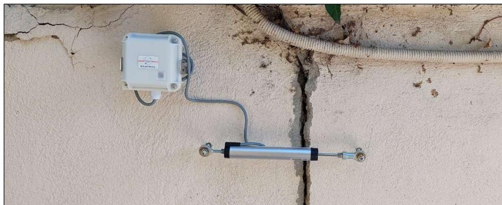
Der vernetzte Rissmonitor R2 wurde für die Messung von Rissbewegungen mit großem Messbereich von bis zu **100 mm** entwickelt.
