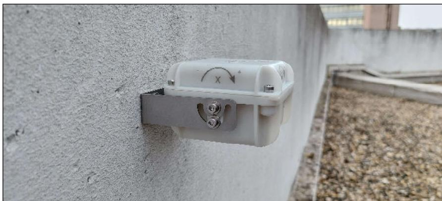
Das R5-Messgerät ist ein vernetztes Inklinometer (Neigungsmesser), das über drei integrierte Sensoren verfügt:
