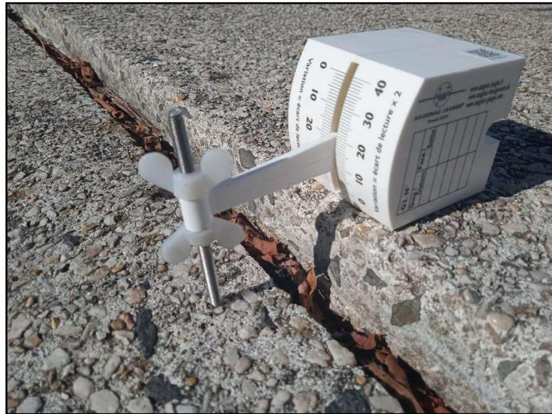
Die G3-Riss-Messlehre eignet sich für die Verfolgung der Entwicklung eines horizontalen und vertikalen Versatzes zwischen zwei Strukturen oder allgemein der Entwicklung einer Bewegung entlang der Z-Achse, die normal zu einer X, Y-Referenzebene verläuft.
