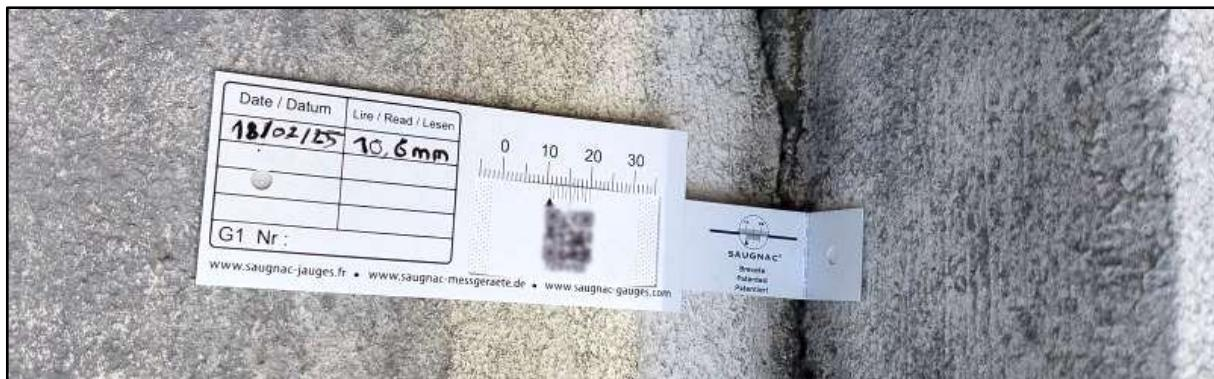
**Frühere Versionen der Messlehrnen der G1-Serie** wurden mit einer flexiblen Lasche geliefert, die eine Winkelbefestigung ermöglicht. Die Lasche hat einen dünneren Bereich, der das Umknicken erleichtert
