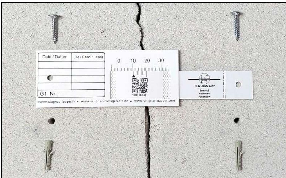
Verwendung von 4-mm Dübeln und 3-mm Breitkopfschrauben
