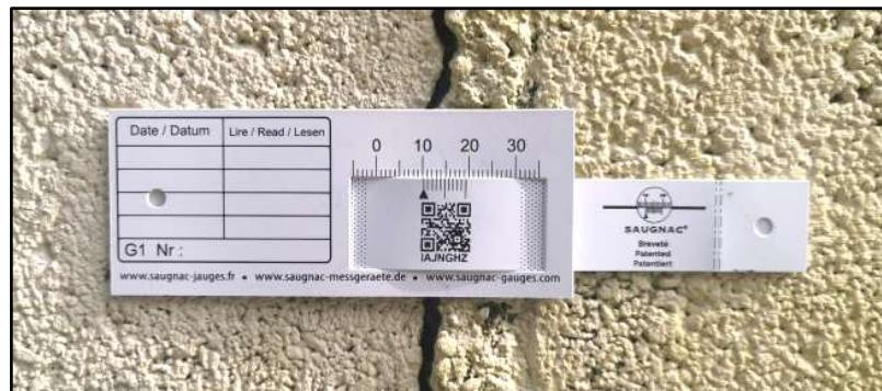
Die G1-Riss-Messlehre wird zur Beobachtung von Rissen mit parallelen Rändern empfohlen. Sie ermöglicht zuverlässige Messungen mit einer Auflösung von 0,1 mm.
