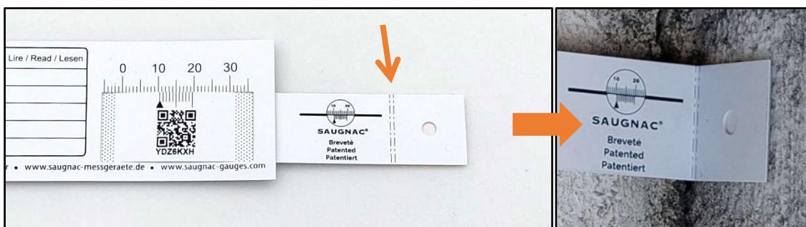
Diese Riffelung erleichtert das Umknicken der Lasche und ermöglicht eine Winkelbefestigung ohne zusätzliches Zubehör.
