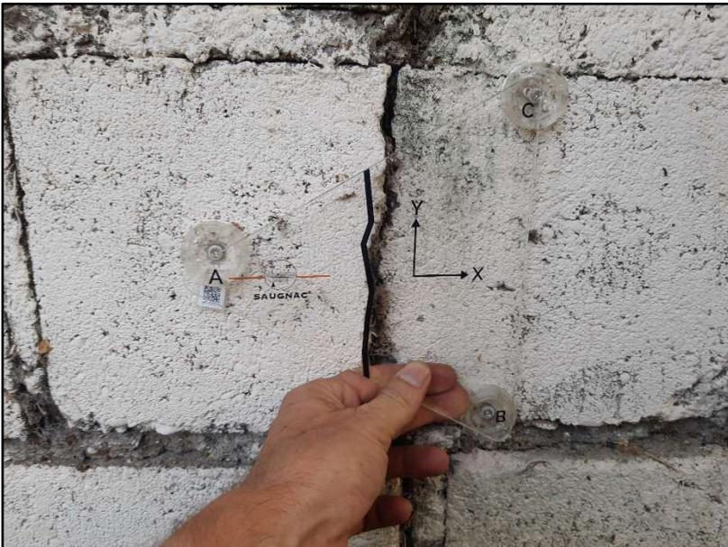
Die Saugnac.app ermöglicht es, diese Werte in ein orthonormales X,Y-Koordinatensystem zu übertragen und daraus die Bewegung auf diesen beiden Achsen abzuleiten.
