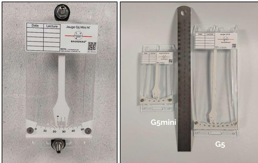
Die G5mini-Messlehre ist ein Neigungsmesser, mit dem die Entwicklung einer Neigung oder eines Kippens (Mauer, Balkon, Schutzwand, Überhang, ...) gemessen werden kann.
