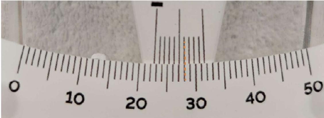
Die untere Teilung ist in mm von 0 bis 50 mm eingeteilt: das ist die Messskala.
