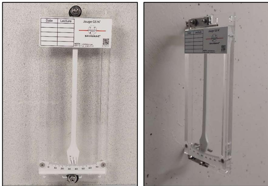
Die G5-Messlehre ist ein Neigungsmesser, mit dem die Entwicklung einer Neigung oder eines Kippens (Mauer, Balkon, Schutzwand, Überhang, ...) gemessen werden kann.
