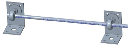
Spezielles Messgerät zur Messung großer Amplituden bei Temperaturen bis 150°C
