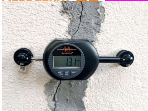
Auf Platinen gesteckter Rissmonitor zur Messablesung
